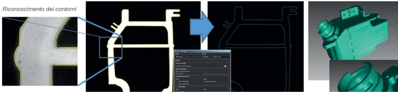
Modello tridimensionale della superficie basato su dati TC
