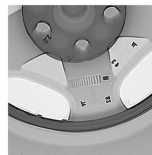
Controllo ai raggi-X di ruote in lega leggera
