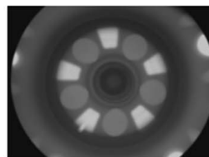
Controllo ai raggi-X di ruote in lega leggera
