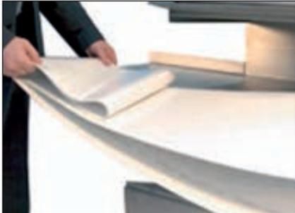
La LUNGHEZZA DEL NASTRO di trasporto è modulare e totalmente configurabile, a seconda delle richieste del cliente o dello spazio disponibile. Il nuovo sistema dotato di MOTO-TAMBURO consente di ridurre la lunghezza del tappeto fino ad 1 m. e di affiancarsi al nastro esistente senza i tipici problemi causati dalle dimensioni dei normali motori esterni.
